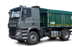
ZKA 1 (16 ton totaalgewicht)
